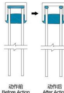
当温度保险丝本体及周边环境温度上升至温度保险丝熔断温度时，在助熔剂发挥表面张力作用下，合金呈球状熔断，切断电路，发挥保护功能。
